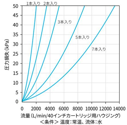
※ システムとしての圧力損失はカートリッジ+ハウジングとして計算します。
