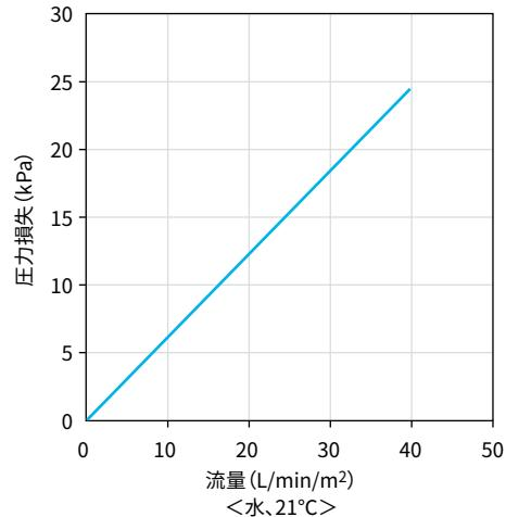
注意：最適なろ過効果を得るため、初期圧力損失 20kPa以下で使用されることをおすすめします。圧力損失管理の目安としては、0.15～0.21MPaでの交換をおすすめします。
