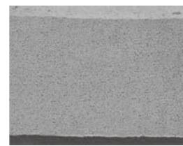
図3: ナイロン66メンブランSEM顕微鏡写真
